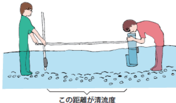
図2 清流度の測定器具及び測定方法
