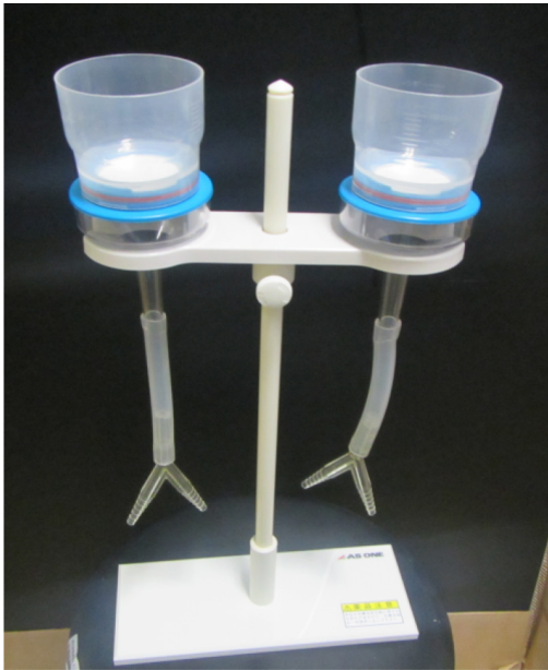
図8 簡易ろ過測定法で用いるろ過装置
