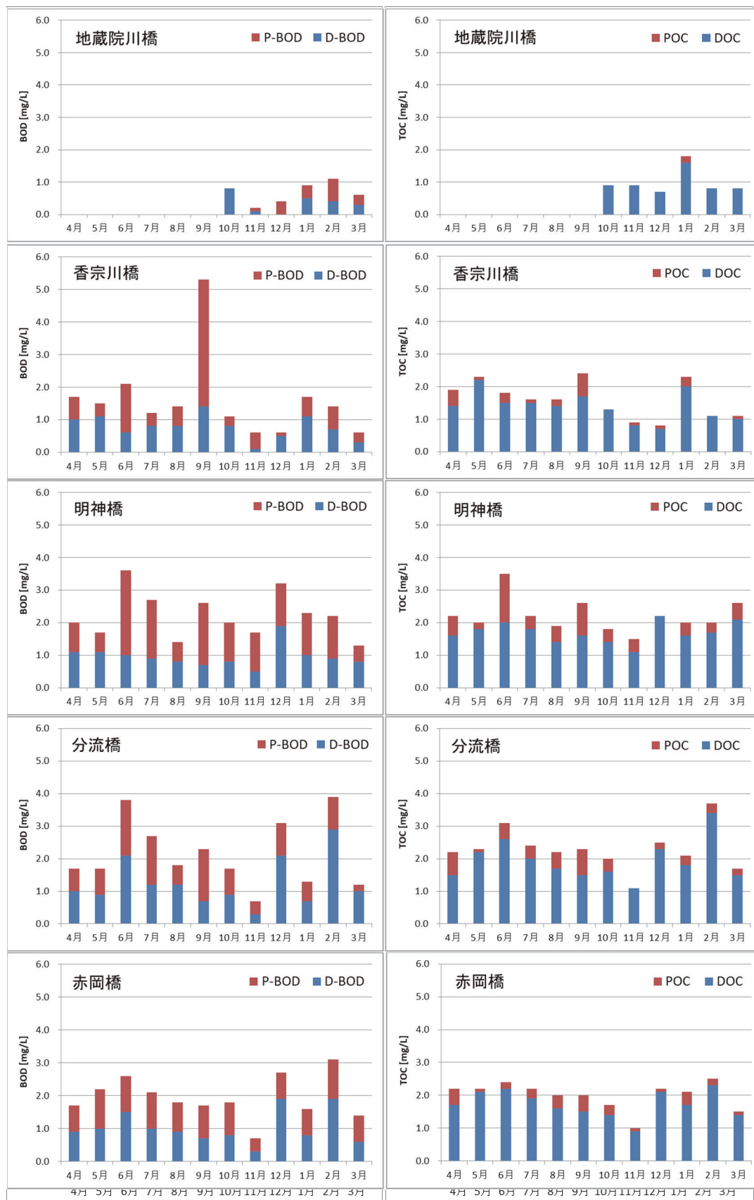
図4 各調査地点の溶存態、懸濁態別のBOD及びTOC
