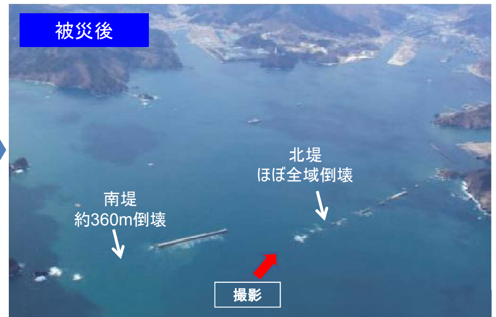
(撮影) 北堤の倒壊状況
