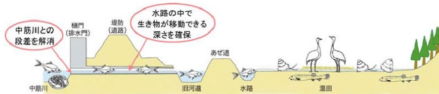
図 2-1-30 樋門の段差解消の整備イメージ
