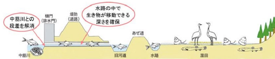
図 2-1-30 樋門の段差解消の整備イメージ
