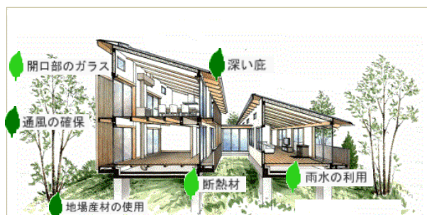
【エネルギー消費を低減する設計のイメージ (環境共生型住宅『高知エコハウス』)】
