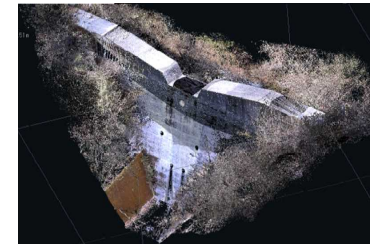
砂防堰堤の3次元点群モデル
