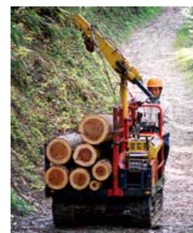
林内作業車では、大きな木を上において安定感を保ちます。
