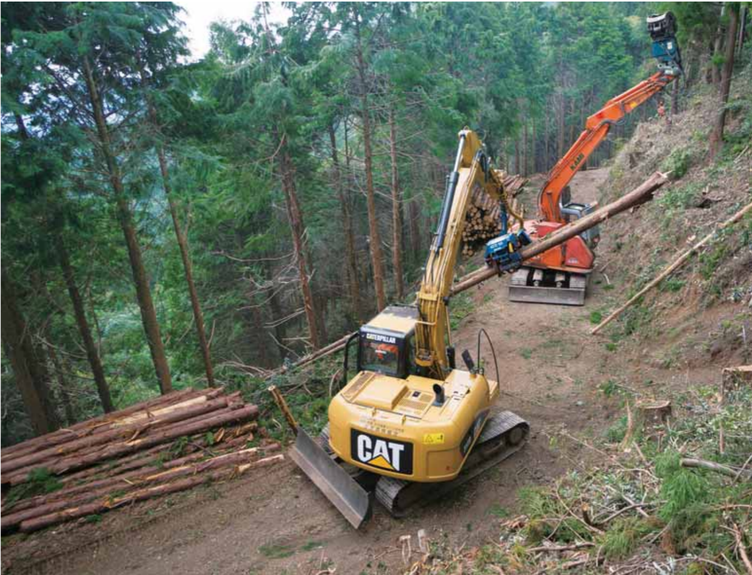
スイングヤーダ（奥）とハバスタ（手前）を組み合わせて、効率の良い作業システムを構築しています。
