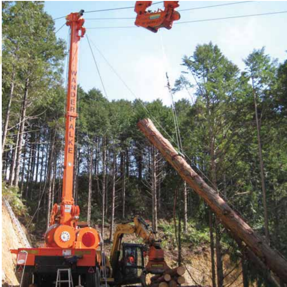
オペレーターがタワーヤーダから離れて操作ができます。また、過負荷がかかった時に自動停止する装置や、オートヨーカー（ラジコン式自動荷外しフック）を併用することで安全な荷外しが可能になるなど、安全作業への配慮がされています。
