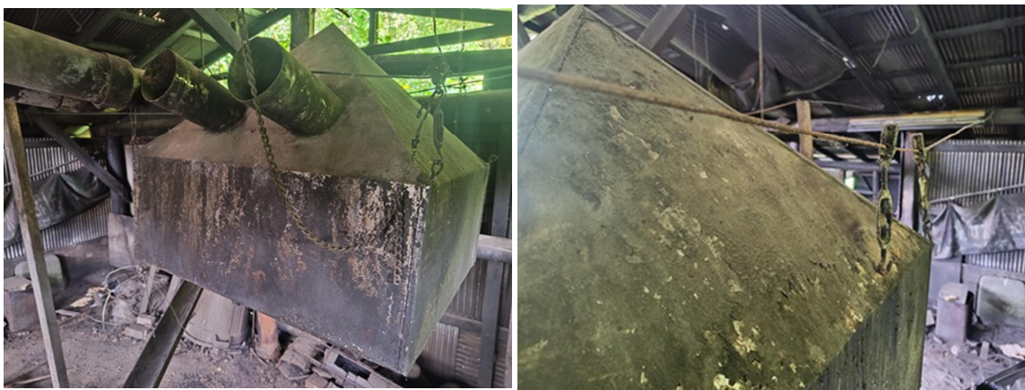
集煙装置：適温の煙のみを集煙出来るよう、煙突上から移動できる。
