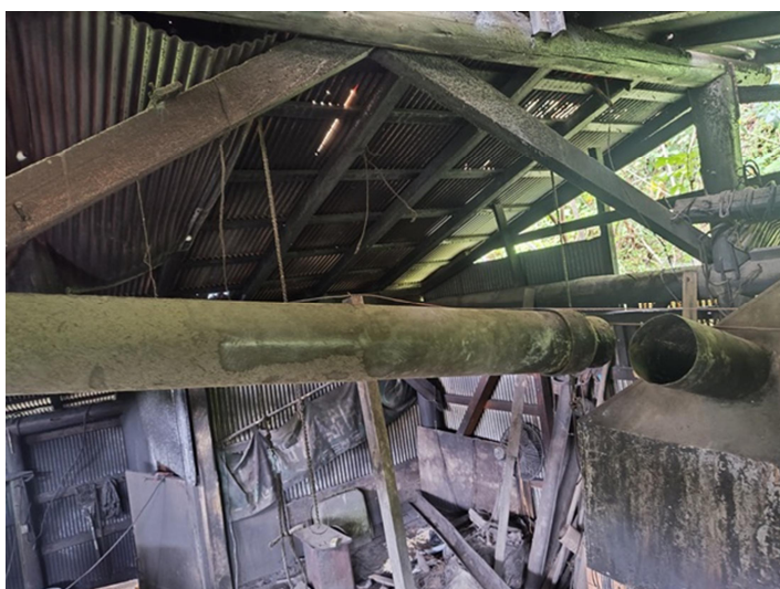
集煙装置：適温の煙のみを集煙出来るよう、煙突上から移動できる。
