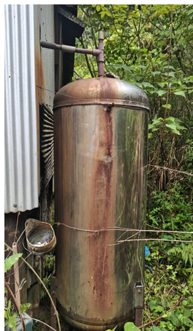
木酢液収集装置：冷却された木酢液は樋で受けてタンクに貯める。
