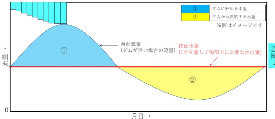
ダムがあることにより、自然流量が豊かな時(①)には水を貯留し、確保流量が不足している時(②)には水を供給して、年間を通じて安定的に利用できる流量を確保している。
