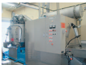
真空乾燥式生ゴミ処理機 生ゴミを粉碎し乾燥処理します。
