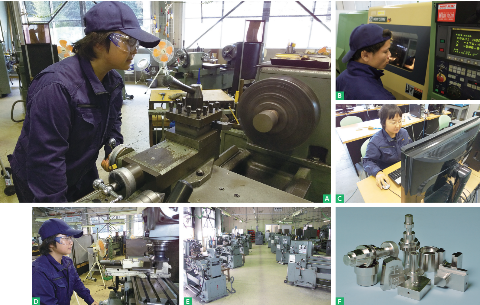
上の写真 A 普通旋盤による切削加工 B NC旋盤のプログラミング C パソコンを使ったCAD製図 D フライス盤による切削加工 E 実習風景(旋盤) F 実習作品例
