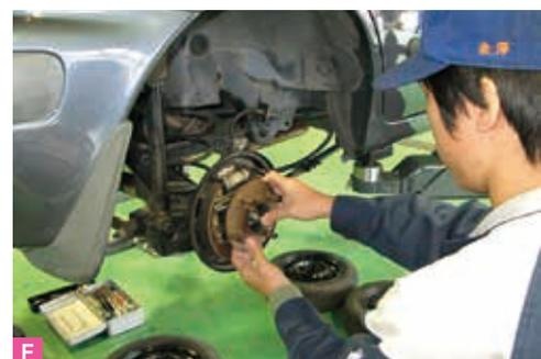
上の写真 A 自動車整備科の仲間たち B エンジン各部品測定 C バッテリー性能試験 D 大阪モーターショー見学 E レーシング・カート整備 F ブレーキ装置整備作業
