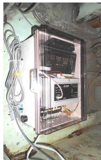
図6 市販FA機器で構成したIoT機器
