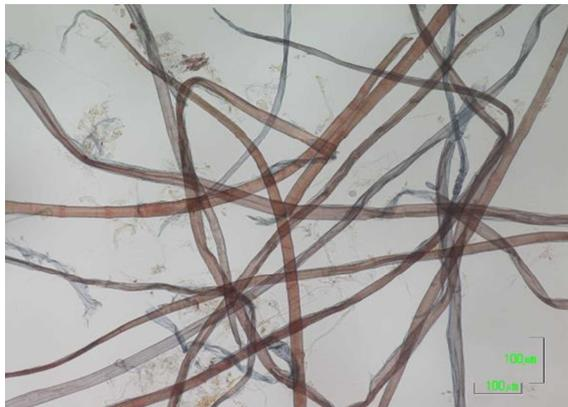
写真2 打解1時間の繊維の顕微鏡写真
