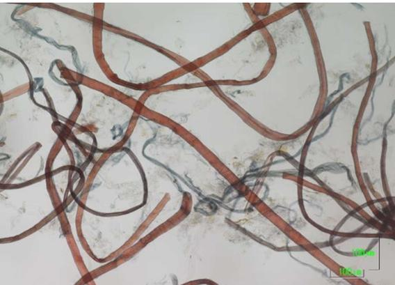
写真3 打解2時間の繊維の顕微鏡写真
