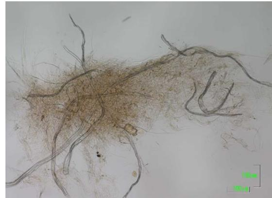
写真6 打解2時間の微細組織の顕微鏡写真
