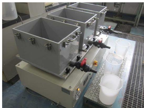
写真1 水解性評価試験装置(スロッシュボックス装置、株式会社日進機械製)
