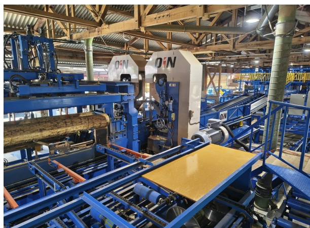
同協同組合が導入した「ロボット式ツイン帯鋸盤」。本機械の稼働により、大径材を効率的に製材することが期待される。
