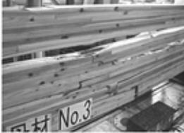
試験後の継手部
