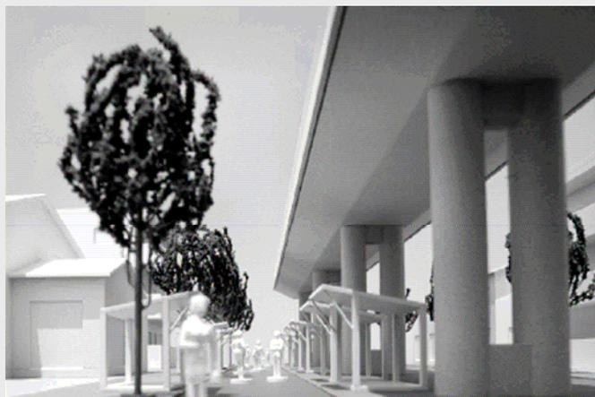
その標準部のデザインをベースに、架道部を含む具体的な設計が進められたが、シンプルなデザインであるだけに、桁のラインが滑らかにつながるように、各構造の接続部に注意を払った。一方、高欄の詳細検討では、既存の高架橋にとり付けた原寸の模型によって、実際のスケール感や日差しによる見え方を確認できた。
