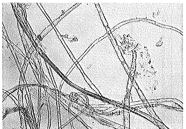
(6) カセイソーダによる膨潤繊維に亀裂あり
