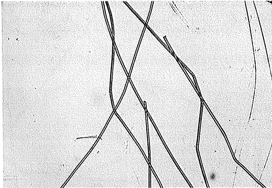
写真13 ①溶剤系セルロース繊維（叩解前）
