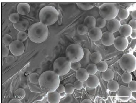
このシートでは、3種類の異なる粒径のガラスビーズが均一に混合されている状態が確認されたが、基材表面全てをガラスビーズが覆っている状態とはならなかった。また、複合シートの紫外線カット性及び断熱性は隙間が多く見られる結果に相関して、紫外線透過率は47.5%、日射反射率は48.0%と低い値を示しており、今回のテストで
