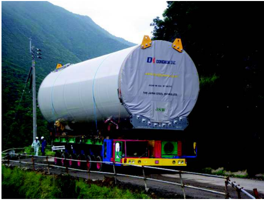
トランスポーターによるボトムタワー輸送
