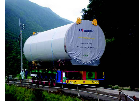
図表 2-6：トランスポーターによるタワー輸送
