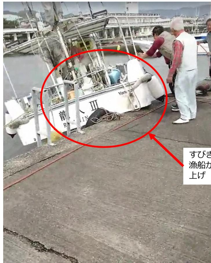
すびき現象により漁船が岸壁に乗り上げ
