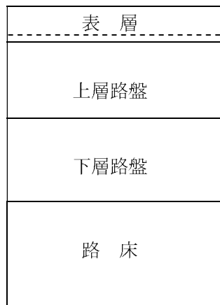
図1 アスファルト舗装の構造
