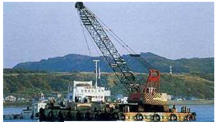
日本作業船協会HPより クレーン台船
