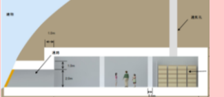
避難シェルター(地下式)
