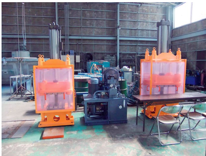
図 3 油圧プレス実証機 (左：30 トン、右：50 トン)
