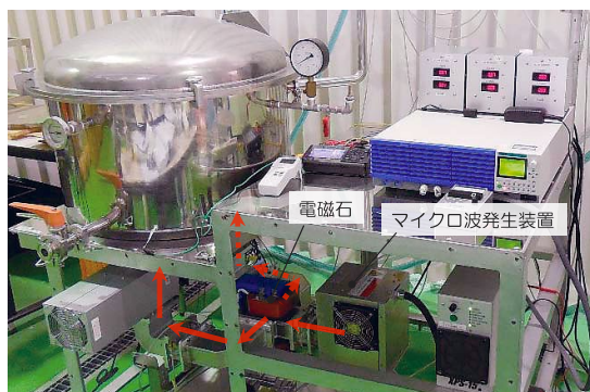
図8 マイクロ波切り替え機の実験装置
