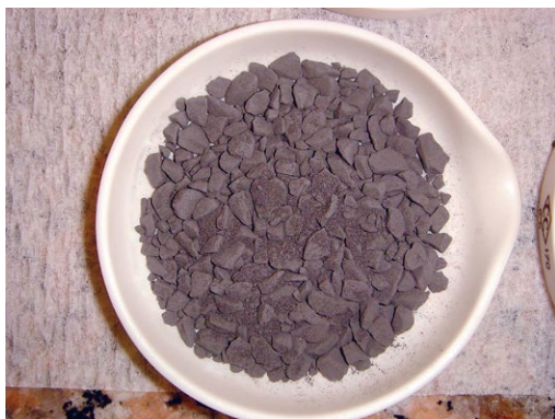
図 1 コークス、塩、石灰石の混合状態
