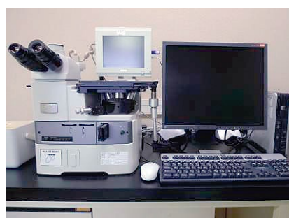
主な使用機材(左:万能試験機、右:金属顕微鏡システム)
