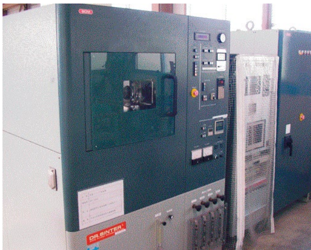
図2 高周波プラズマ放電焼結装置
