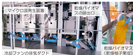
図6 マイクロ波発生装置の廃熱を利用した温風乾燥装置
