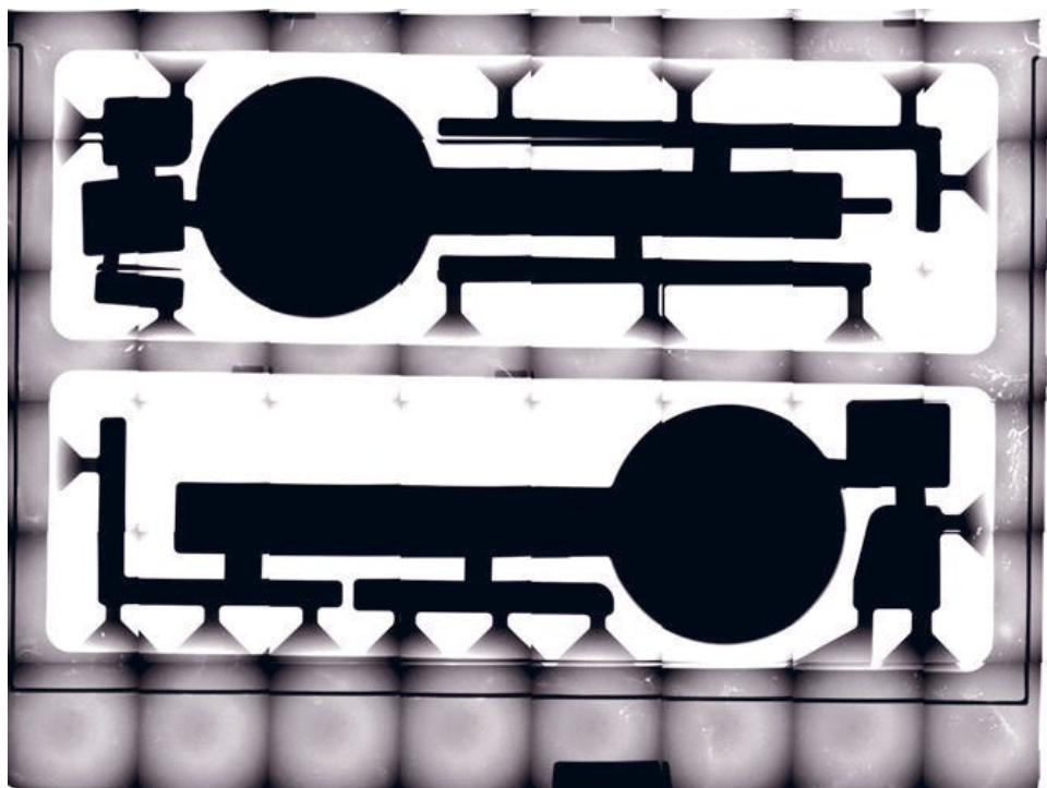
図 4 対策品の X 線透過試験結果
