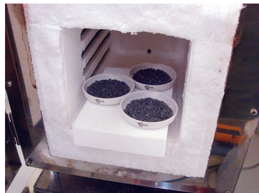
図 2 電気炉による塩焼き試験
