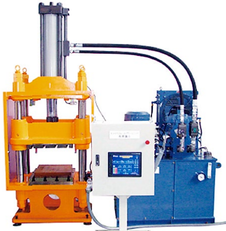
図1 実証用プレス機と 一次試作油圧ユニット
