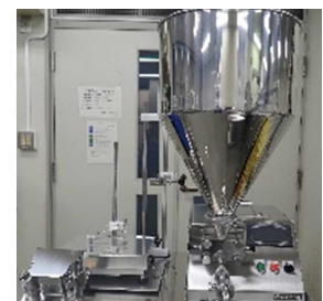
③ 粘体充填機 RD-703
