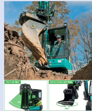
バケットの傾斜（チルト）や、回転（ローテート）が可能
