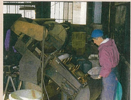
①頭切り 頭と胴体を分ける。ヘッドカッターを使い労力を軽減している。
